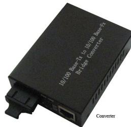
Converter quang điện
