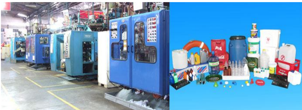
(Máy thổi chai nhiều lớp – sản phẩm công ty đang sản xuất)
