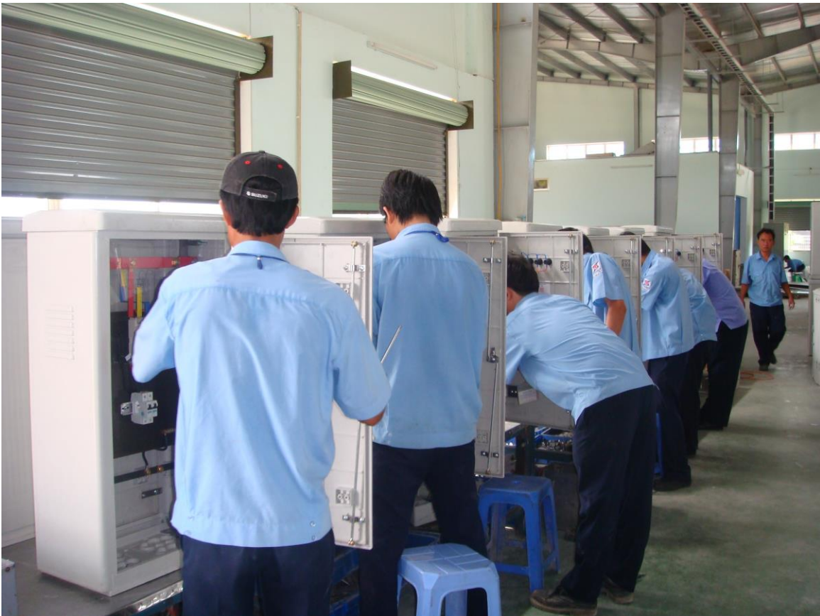
Sản xuất Tủ điện lực
