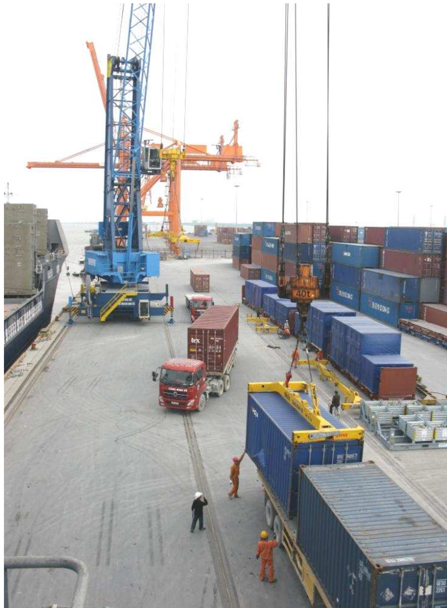
Mobicrane- cần cẩu bờ có sức nâng 100 tấn, tầm với 50m
