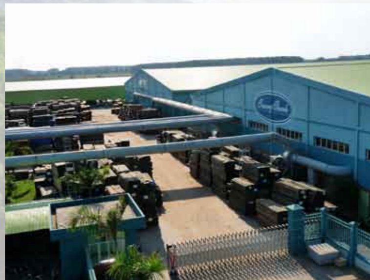
Hệ thống hút bụi 300HP phía sau nhà máy
