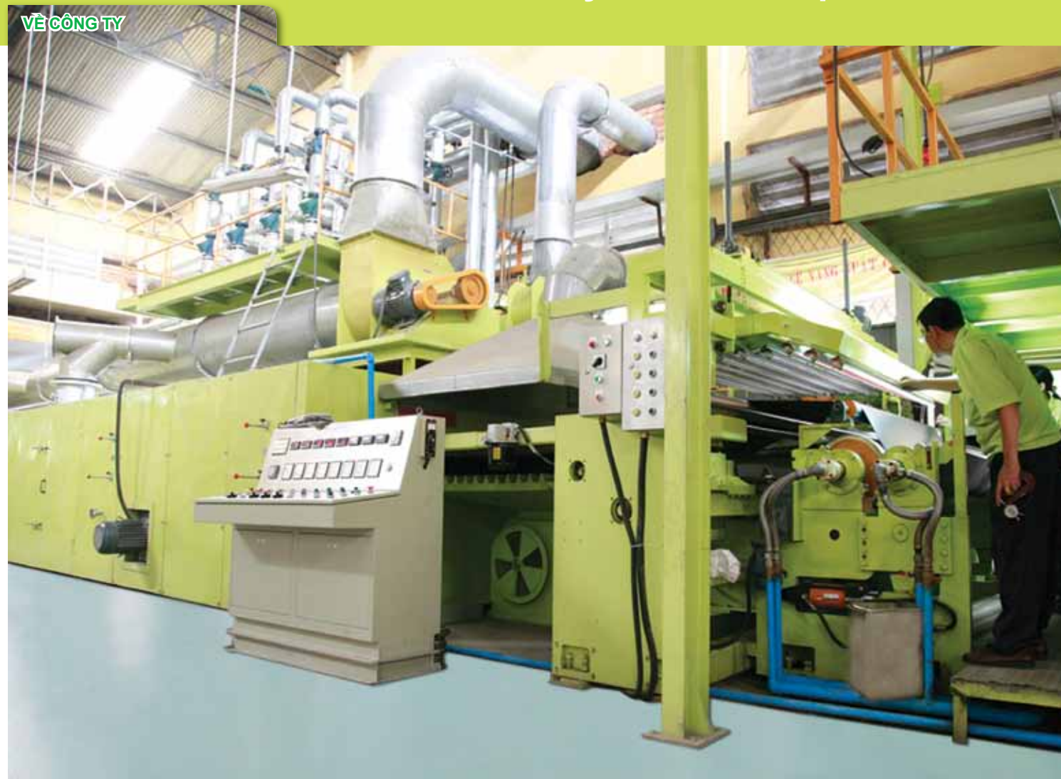
Máy hấp xốp, phục vụ sản xuất giả da
