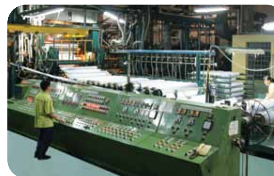
Dây chuyền máy cán phục vụ sản xuất màng mỏng
