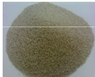
Cát lọc nước
