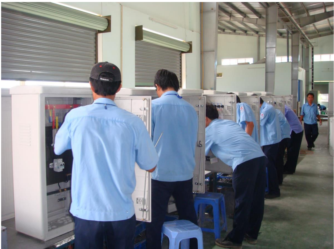
Phân xưởng sản xuất Tủ điện lực
