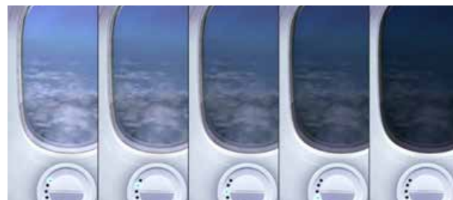
Cửa sổ thông minh được sử dụng trong máy bay thế hệ mới nhất Boeing 787 6
