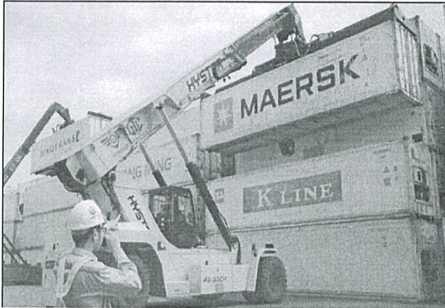
Quá trình bốc xếp container bằng máy nâng
