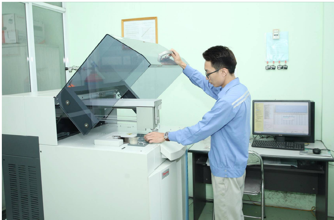
Phân tích Chỉ tiêu Lưu huỳnh trong than trên thiết bị LECO-S832
