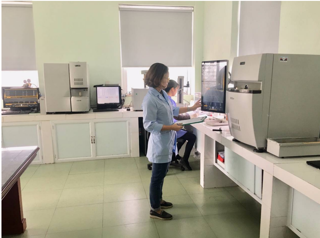
Phân tích Chỉ tiêu Lưu huỳnh trong than trên thiết bị LECO-S832
