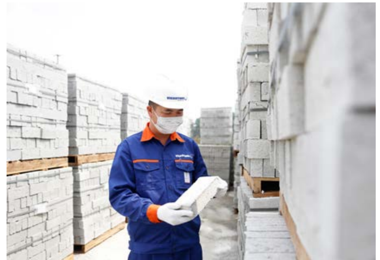
Bùn thải được sử dụng làm nguyên liệu để sản xuất gạch không nung
