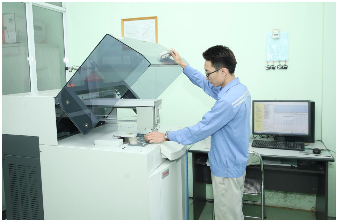
Phân tích Chỉ tiêu Lưu huỳnh trong than trên thiết bị LECO-S832
