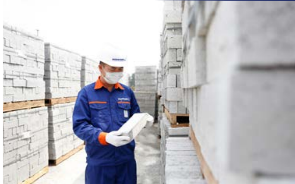
Cán bộ kỹ thuật kiểm tra chất lượng sản phẩm gạch không nung theo công nghệ Geopolymer từ bột đá thải của Công ty
