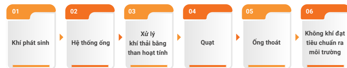
Sơ đồ nguyên lý xử lý khí thải
