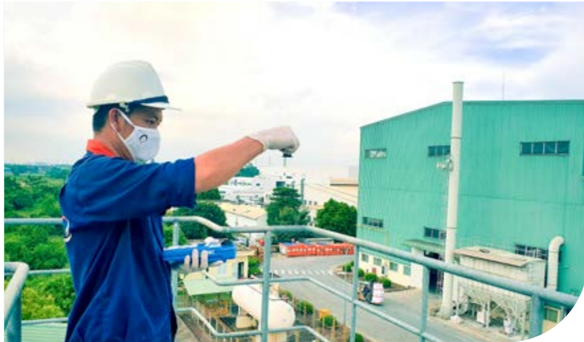
Nhân viên đo chất lượng nước tuần hoàn trước khi cấp nước cho dây chuyền mài
