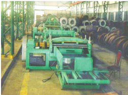
Dây truyền máy cắt thép cuộn cán nguội tự động được chế tạo tại Nhật Bản
