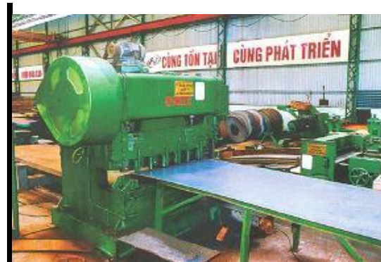
Dây truyền máy cắt thép cuộn cán nóng được chế tạo tại Nhật Bản
