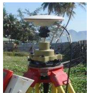
Máy định vị GPS Leica 1200 (Thụy Sĩ)
