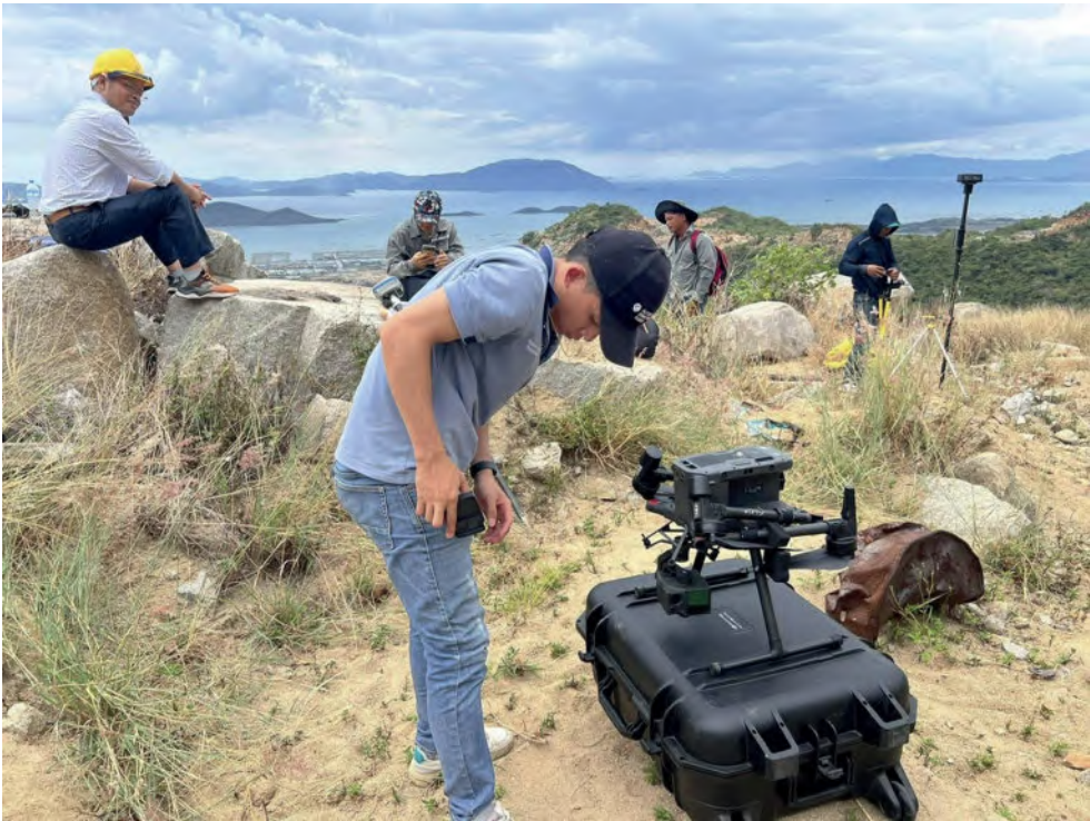
Công tác khảo sát hiện trường bằng Công nghệ bay chụp LiDAR, Dự án Đường dây 500kV Vân Phong – Bình Định
