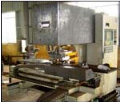
Máy đột thép tấm P803A - CNC ( Ficep Italy)
