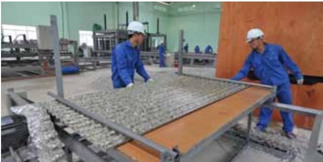
Sản xuất tấm lợp từ nhôm và nhựa tách ra từ vỏ hộp sữa
