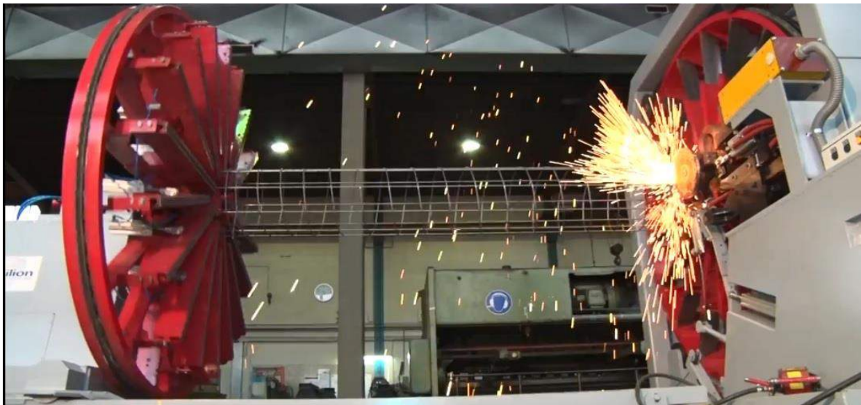
Máy hàn lồng thép cổng tròn tự động và định hình khuôn cổng
