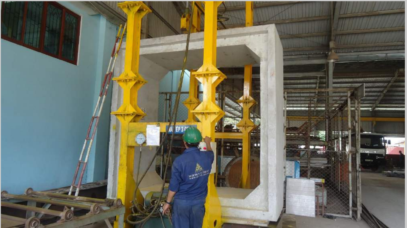
Sản phẩm công được kiểm định chất lượng bằng máy ép ba cạnh được chứng nhận bởi Trung tâm 3
