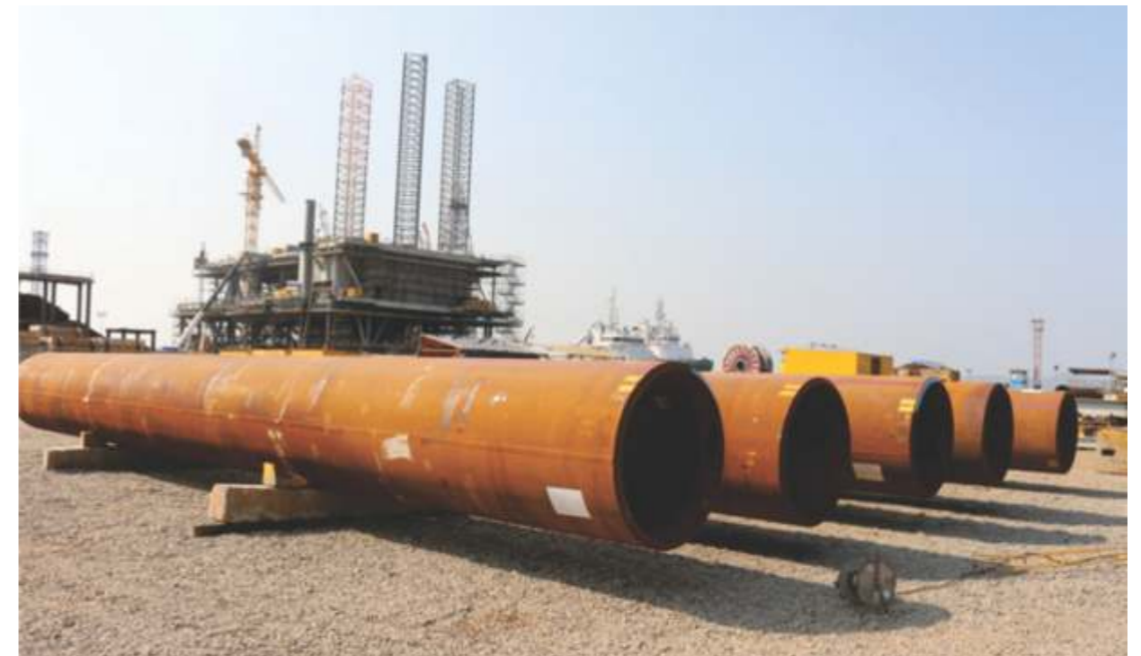
Thi công thực hiện hợp đồng cung cấp dịch vụ chế tạo SVSW Piles and Conductor Piles cho PTSC M&C thuộc Dự án Sư Tử Vàng Tây Nam
