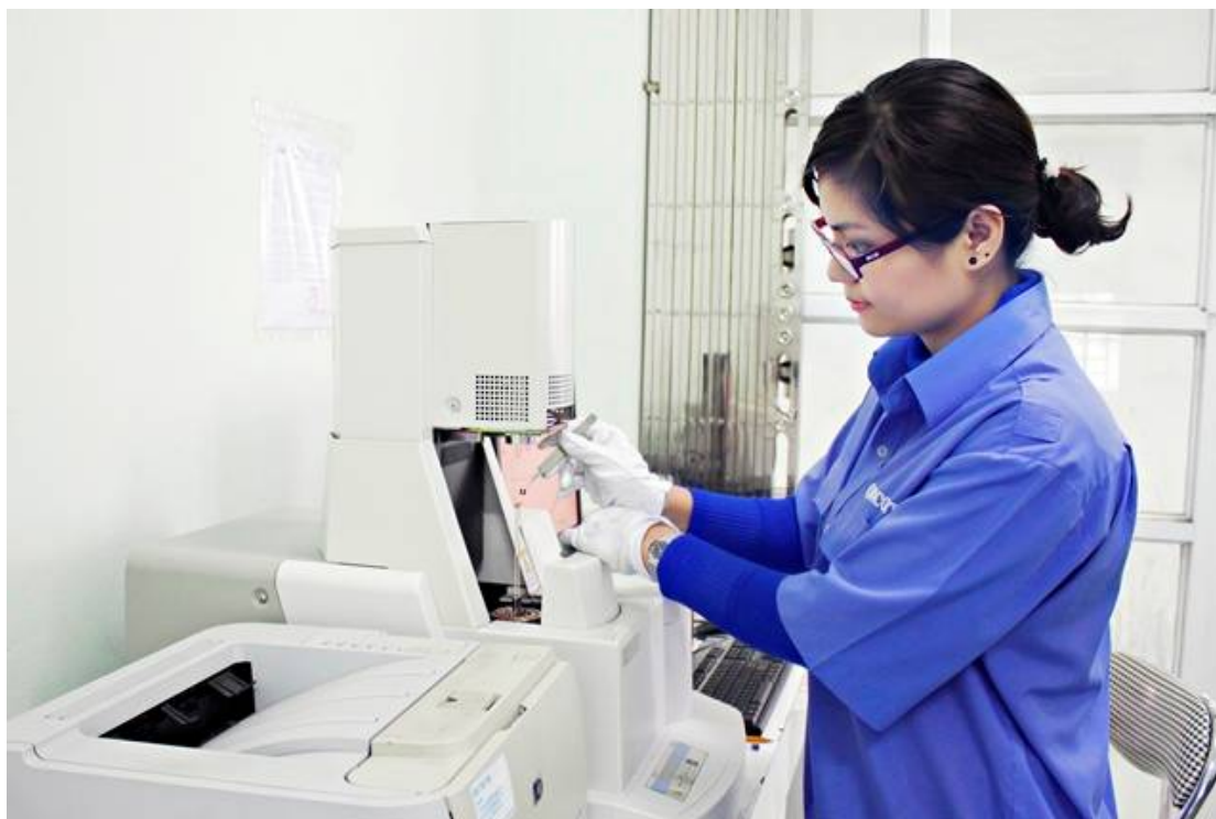
Xác định độ bắt cháy của than trên máy DTG 60 SHIMADZU
