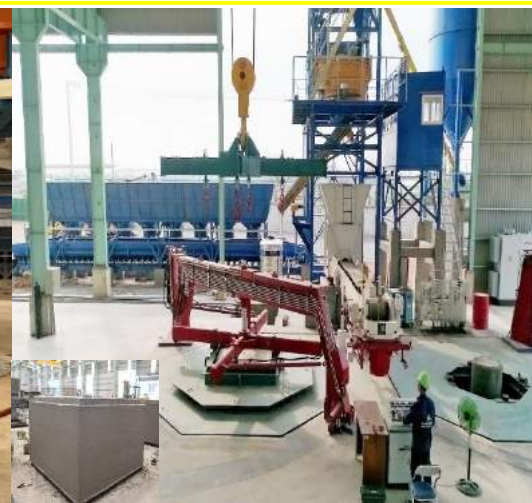
Cống hộp sản xuất bằng công nghệ rung lõi
