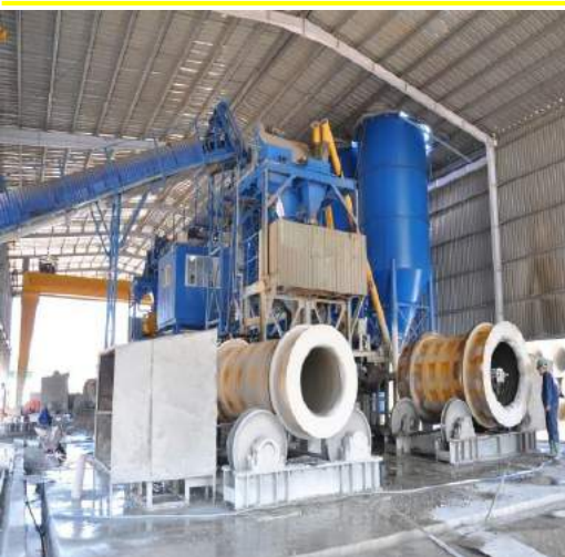
Cống tròn sản xuất theo công nghệ quay ly tâm
