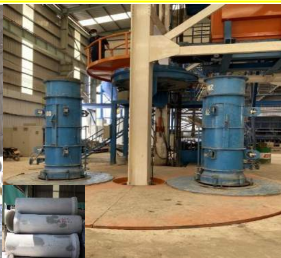
Cống tròn sản xuất theo công nghệ quay ép
