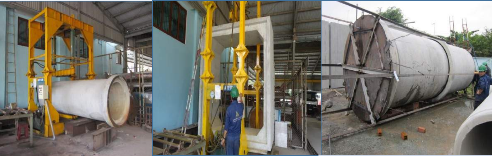
Máy ép 3 cạnh được Trung tâm Kỹ thuật Tiêu chuẩn Đo lường Chất lượng 3 chứng nhận
