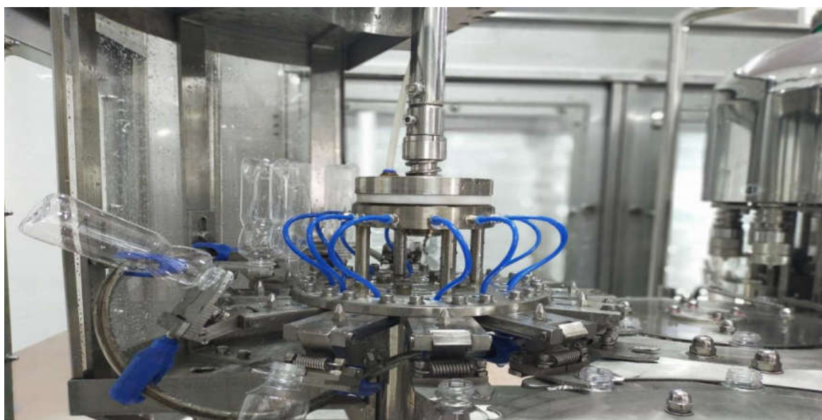
Hệ thống chiết rót chai
