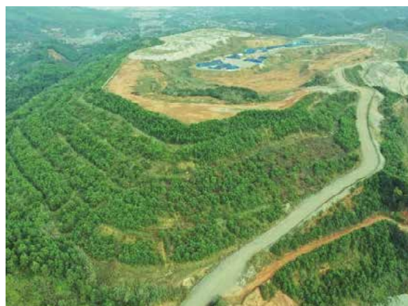
Bãi thải phía Bắc được trồng cây Keo để cải tạo, phục hồi môi trường
